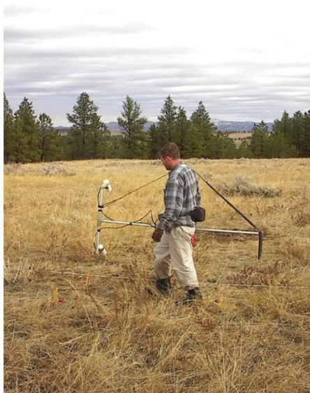
Figur 1 Traditionelle magnetiske opmålingsmetoder. (Venstre) Helikopter-baserede setup med magnetometre placeret for enden af "booms". (Højre) Gående setup med håndholdte magnetometre.
